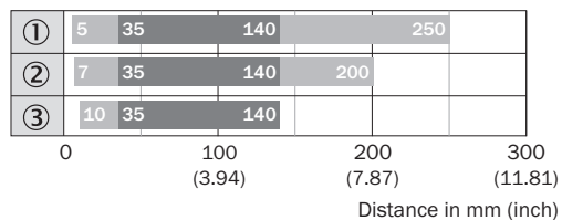
触发感应距离图表 GTB6
